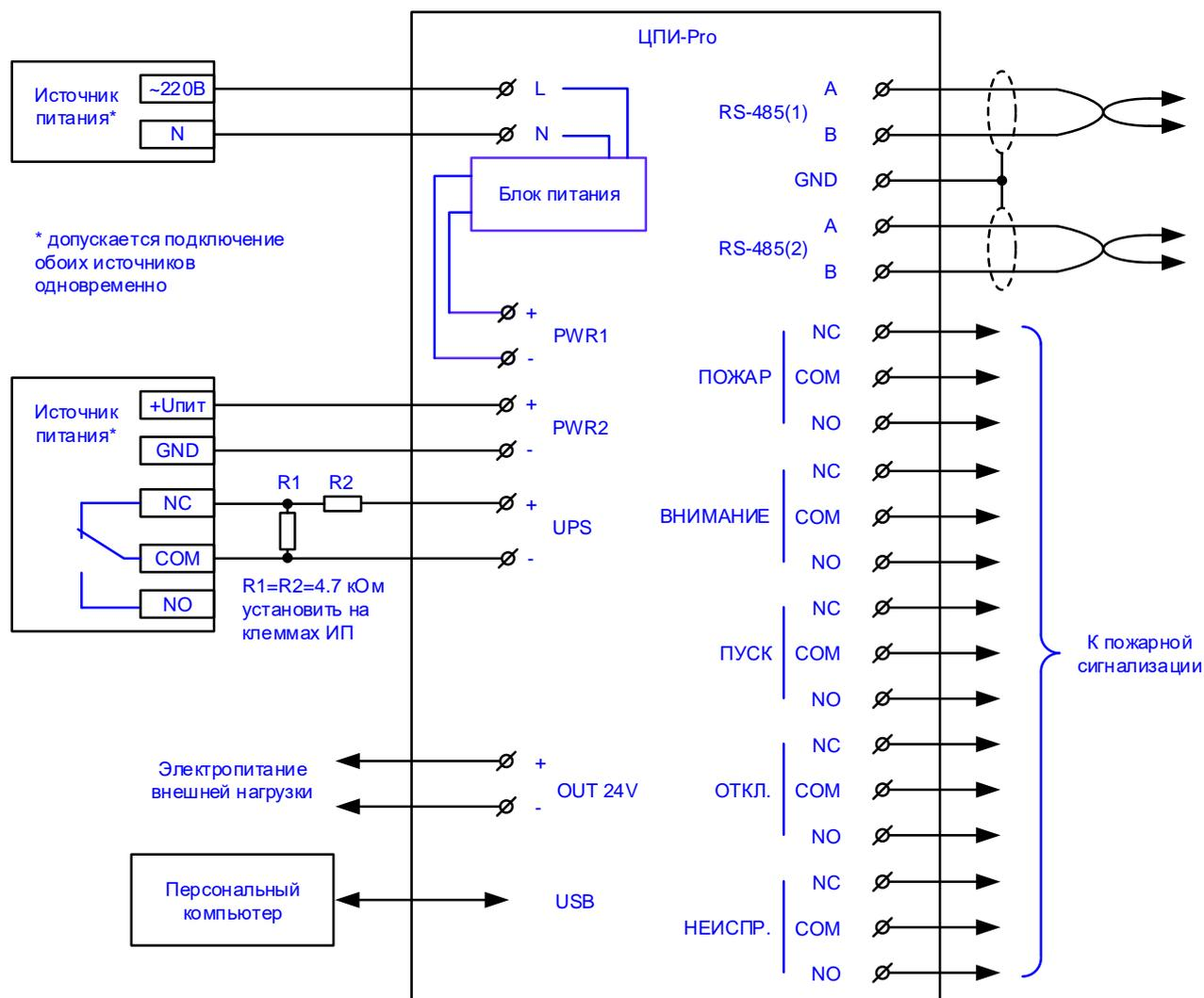
Схема подключения ЦПИ-Light
