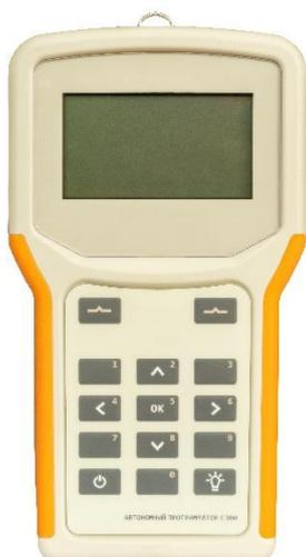
Программатор предназначен для задания сетевых адресов, функциональных возможностей и чтения параметров адресных устройств протоколов С300 и 200АР.
