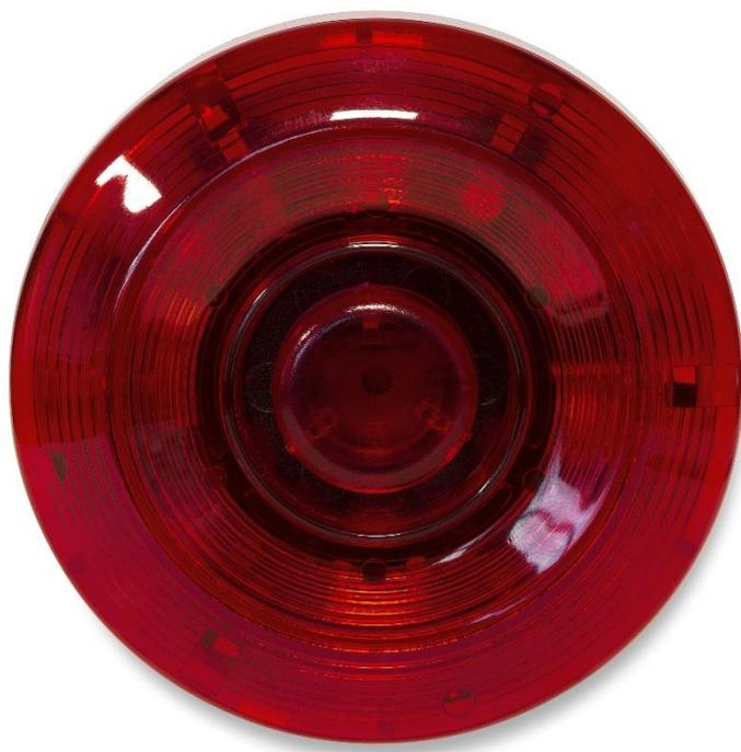
Данный оповещатель предназначен для оповещения людей о пожаре и путях эвакуации посредством подачи светового и звукового сигналов по командам от панели адресной ПАС300. Оповещатель имеет встроенную световую индикацию, а также встроенный изолятор короткого замыкания. Оповещатель работает как по протоколу С300, так и по протоколу 200АР.
